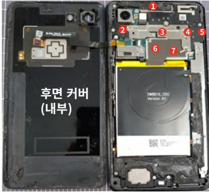
그림 9: 후면 커버가 제거된 구글 픽셀 3XL. 그림의 7개 위치에서 압축성이 높은 폴리머를 활용해 기존 에어갭의 두께를 측정하였다.
