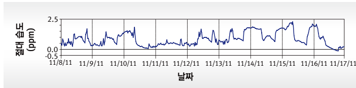
그림 7: 벤트가 미설치된 조명 기구와 벤트가 설치된 조명 기구의 내부 습도 차이
