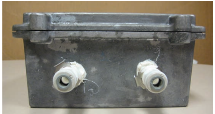
그림 2: 압력 및 온도 테스트를 위해 포트가 설치된 알루미늄 합체
